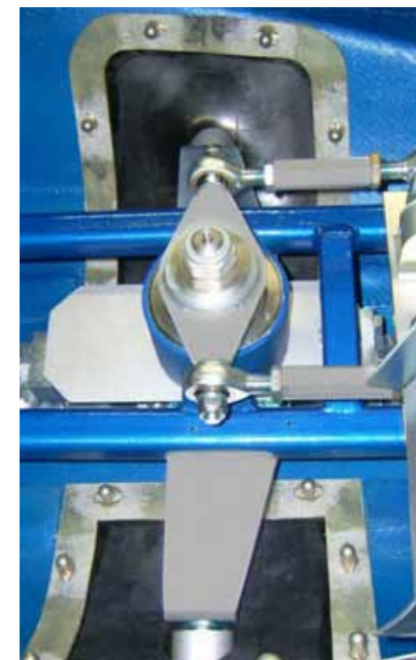
Gelenkköpfe mit Koppelstange zum Justieren der Kufen
